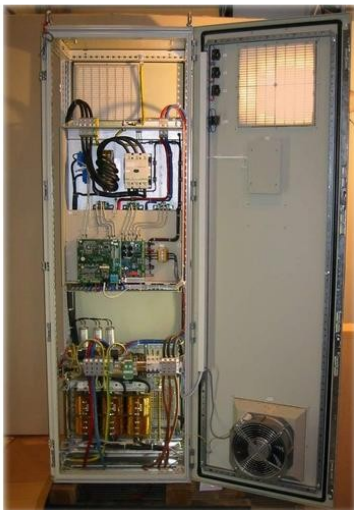
3. ábra: Az SPS-50 típusú napelemes áramforrás
